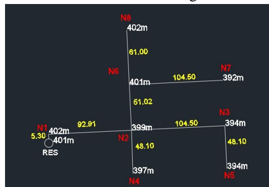
Figura 12- Rede ramificada de abastecimento de água
